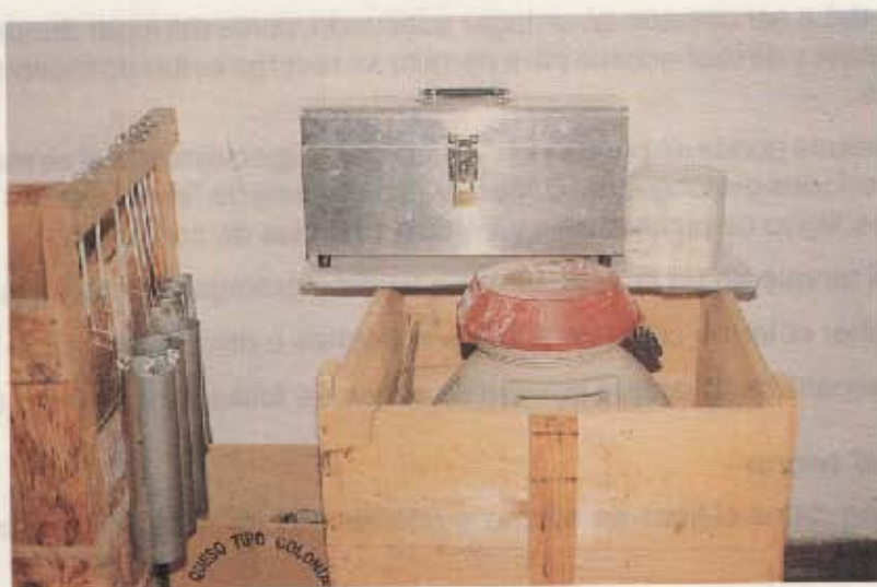
Figura 26. Termo de nitrógeno líquido protegido dentro de una caja de madera. Encima del termo se aprecia la caja metálica que contiene el material de inseminación y a la izquierda canisters sin uso.
